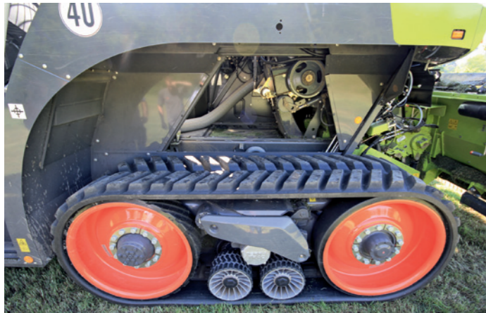
Der Körner-Cracker kann einfach über dem Laufwerk ausgebaut werden – praktisch.
